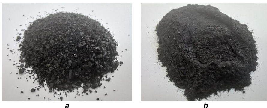
Рис. 5. Продукты обогащения шламов угольного гидроотвала: а – угольный продукт; б – железосодержащий концентрат Fig. 5. Products of sludge dump coal enrichment: а – coal product; б – iron-containing concentrate
