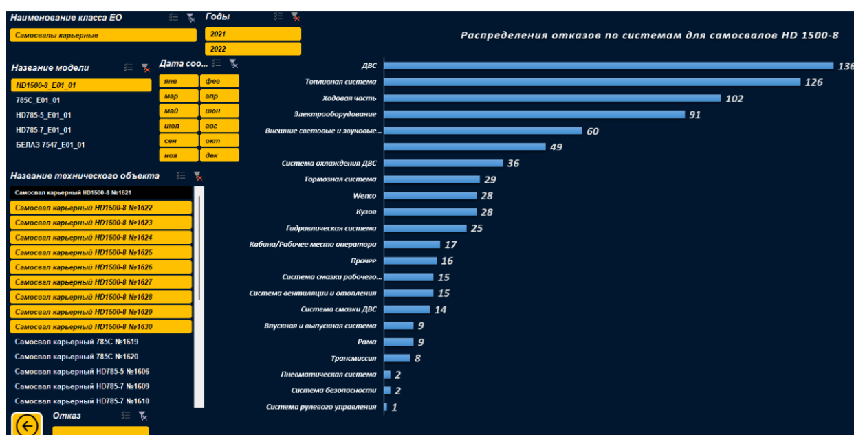
Рис. 2. Информационное окно дашборда с указанием распределения отказов по системам карьерных автосамосвалов HD1500-8
