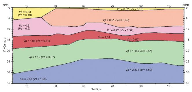
Рис. 6. Сейсмический разрез по профилю на территории кинотеатра «Горизонт»: Vp – сейсмические скорости продольных волн; Vs – сейсмические скорости поперечных волн Fig. 6. Seismic profile section on the territory of the Horizon cinema:
