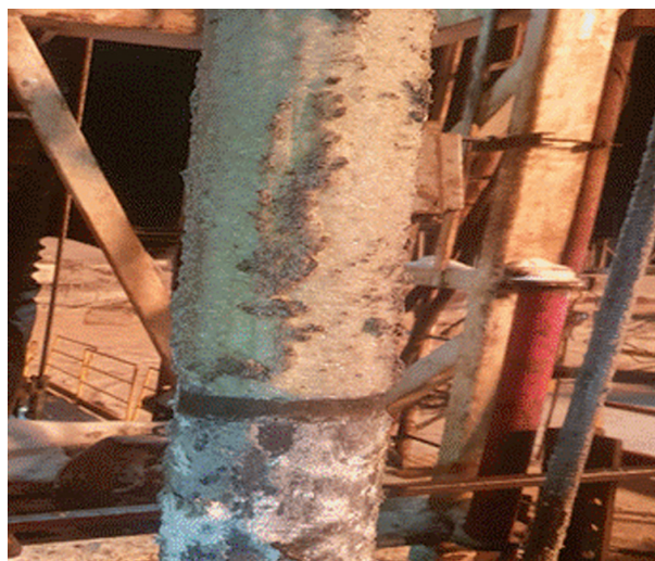
Рис. 6. Солеотложения (кальцит) на внутрискважинном оборудовании Фото предоставлено геологом АО «Верхнехонскнефтегаз» А.А. Ваниным
