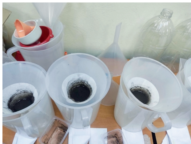
Рис. 2. Процесс фильтрации пробы Fig. 2. Sample filtration process
