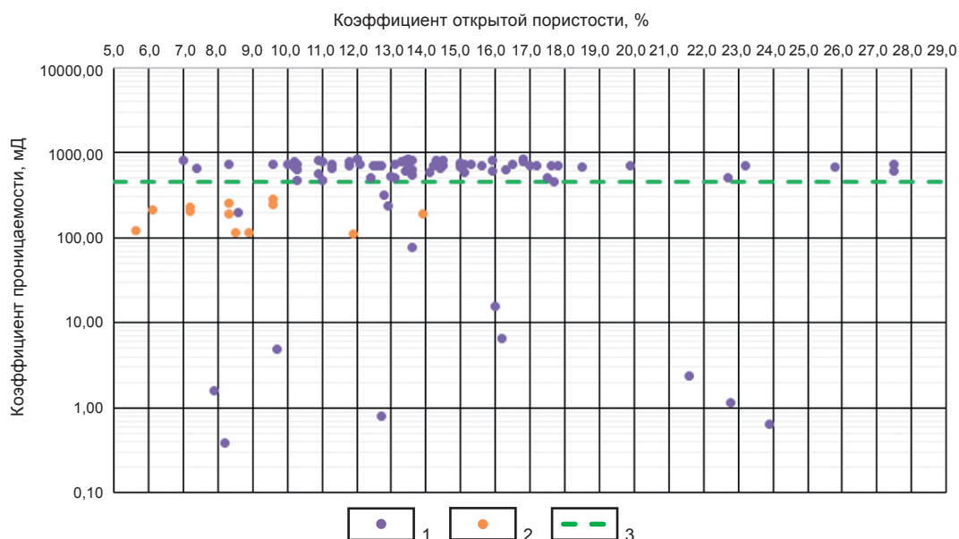
Рис. 4. Соотношение коэффициентов открытой пористости и абсолютной проницаемости K_n/K_{np} песчаников в пласте Vcr^{II} :
