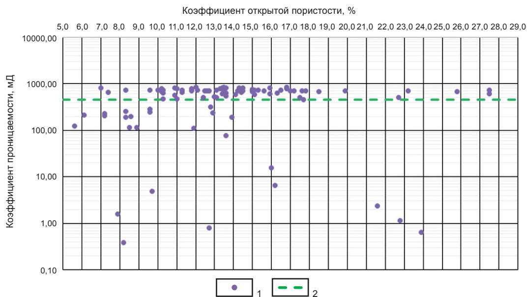
Рис. 2. Соотношение коэффициентов открытой пористости и абсолютной проницаемости K_n/K_{пр} песчаников пластов Vbk_1^{bt}-Vcr^{dl} :
