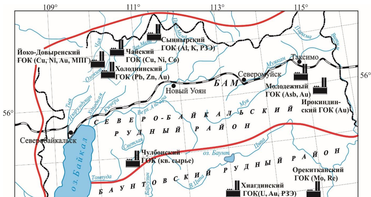
Рис. 2. Схема размещения планируемых горно-обогатительных комбинатов в Северо-Байкальском и Баунтовском рудных районах [2, 8] с дополнением Fig. 2. Allocation scheme for the planned ore mining and dressing plants in the North Baikal and Bauntovsky ore districts [2, 8], updated
