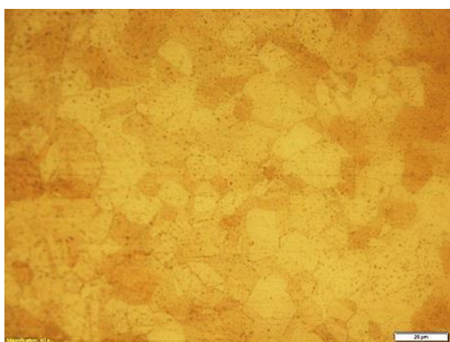
Рис. 4. Микроструктура латуни марки Л63, исходный образец (увеличение 400х) Fig. 4. Microstructure of CW508L brass, initial sample (400x magnification)
