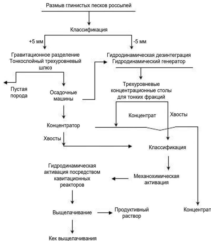
**Рис. 4. Технологическая схема переработки высокоглинистых россыпей с использованием гидродинамических генераторов и кавитационных реакторов стационарного типа**
