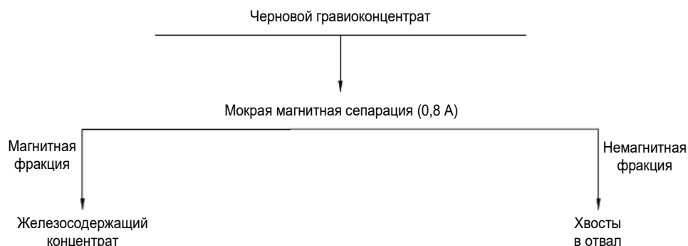
Рис. 2. Технологическая схема доводки гравеоконцентрата методом мокрой магнитной сепарации Fig. 2. Technological scheme of gravity concentrate upgrading by wet magnetic separation
