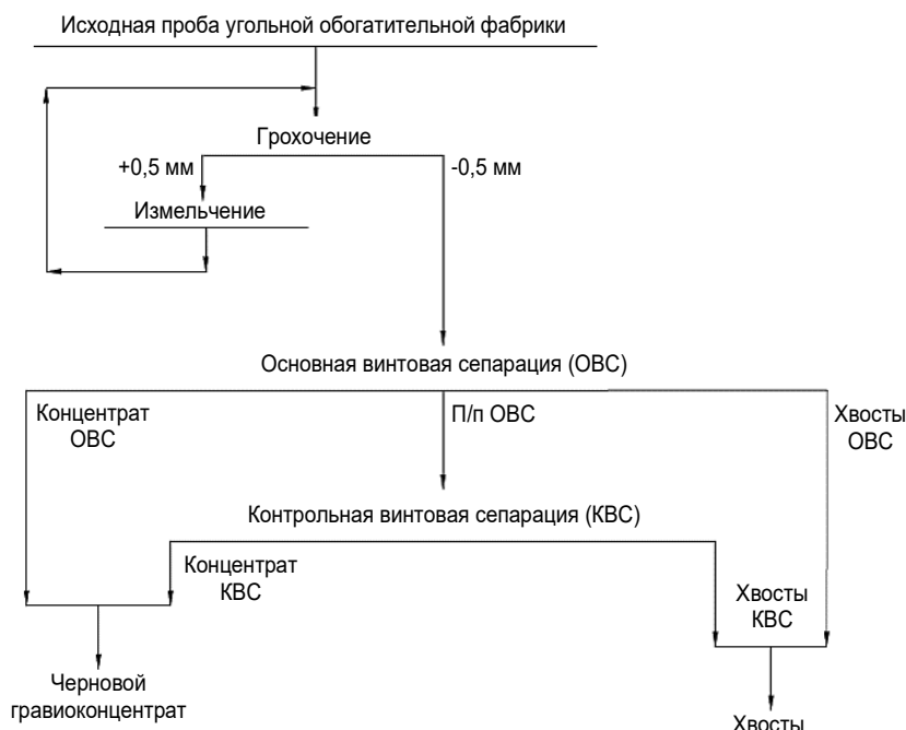
Рис. 1. Технологическая схема обогащения пробы отходов угольной обогатительной фабрики при получении чернового гравеоконцентрата
