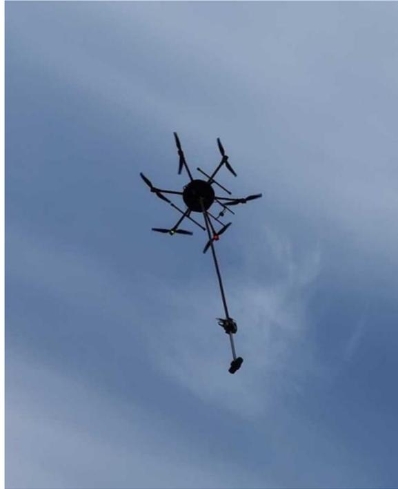
Рис. 1. Беспилотная аэрогеофизическая система SibGIS UAS в варианте для магнитной съемки
