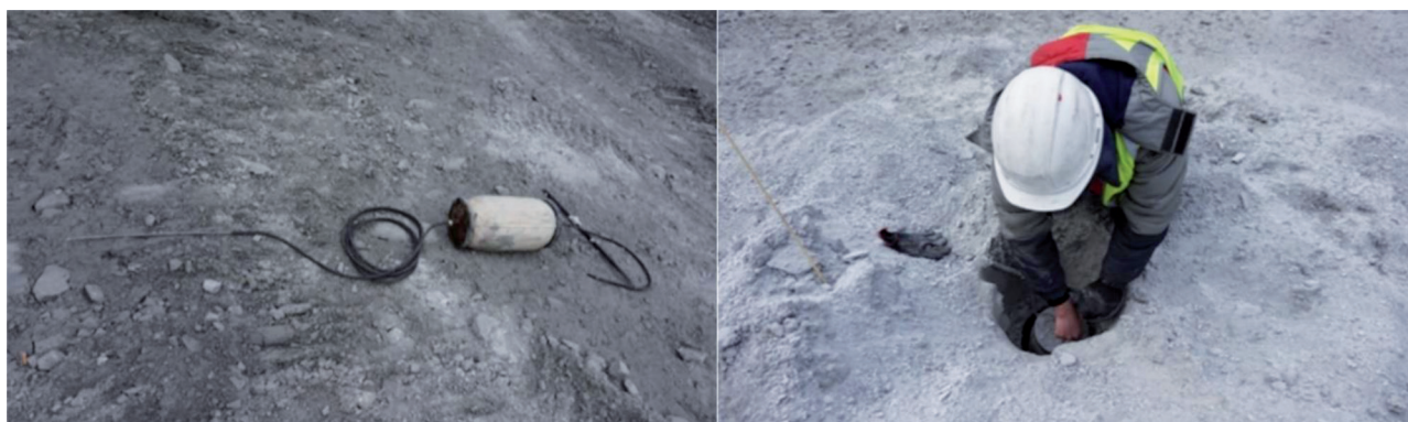
а б Рис. 2. Газовый пробоотборник в комплекте с пакером (а) и установка пакера в ствол буровзрывной скважины (б)
