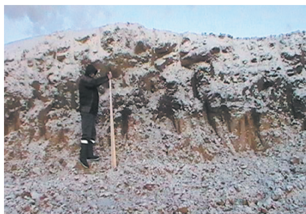
Рис. 3. Замер глубины траншеи выбираемого почвогрунта с промплощадки Ангарского металлургического завода, 2013 г. (фото авторов)
