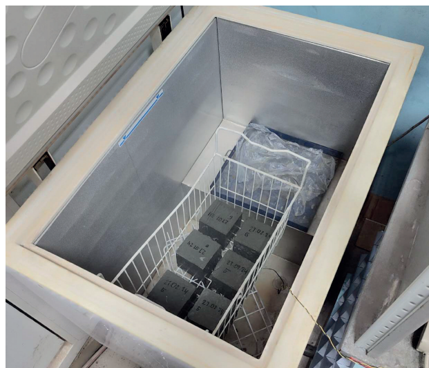
Рис. 1. Цикл морозостойкости с бетонными образцами:
