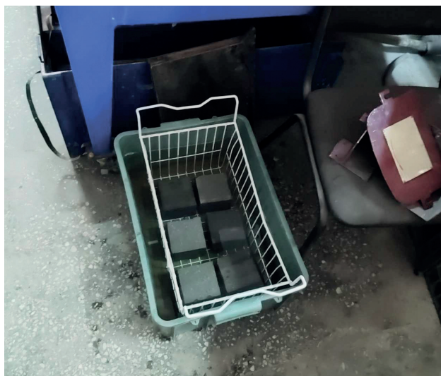
Рис. 1. Цикл морозостойкости с бетонными образцами:
