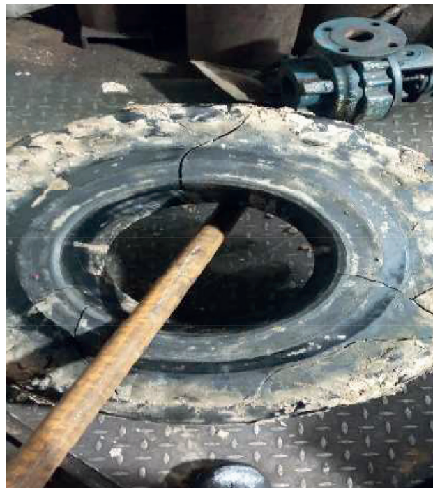
Рис. 3. Поврежденный уплотнительный элемент (фото авторов статьи):
