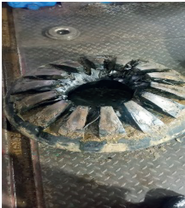
Рис. 3. Поврежденный уплотнительный элемент (фото авторов статьи):
