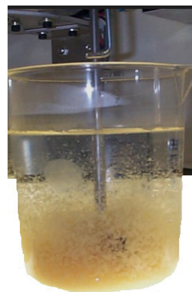
Рис. 2. Коагуляция жидкой фазы буровых отработанных растворов Fig. 2. Coagulation of the liquid phase of spent drilling muds
