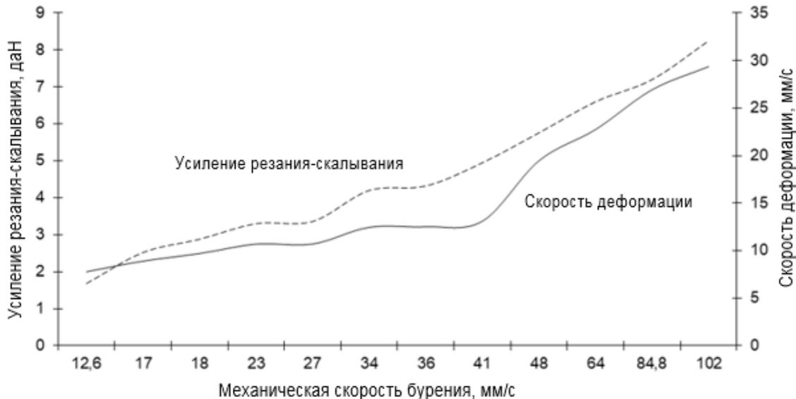
**Рис. 1. Зависимости между механической скоростью бурения, усилием резания-скалывания и скоростью деформации твердой горной породы**
