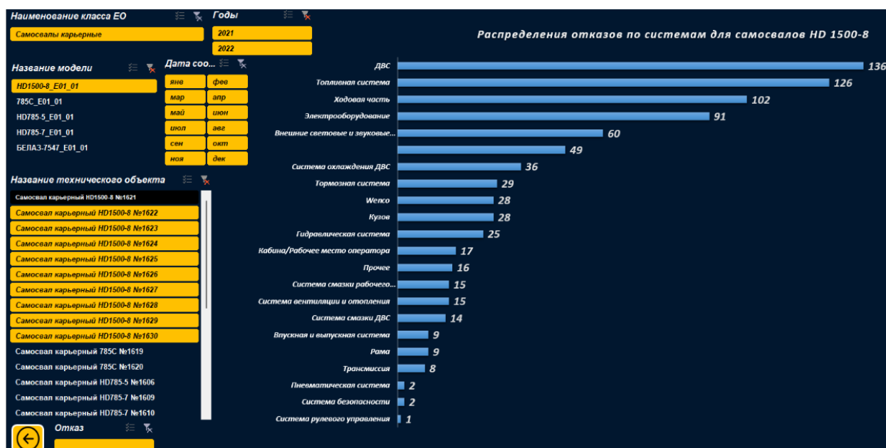
Рис. 2. Информационное окно дашборда с указанием распределения отказов по системам карьерных автосамосвалов HD1500-8
