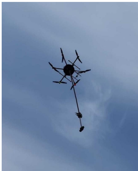
Рис. 1. Беспилотная аэрогеофизическая система SibGIS UAS в варианте для магнитной съемки Fig. 1. Unmanned airborne geophysical system SibGIS UAS in the magnetic survey version
