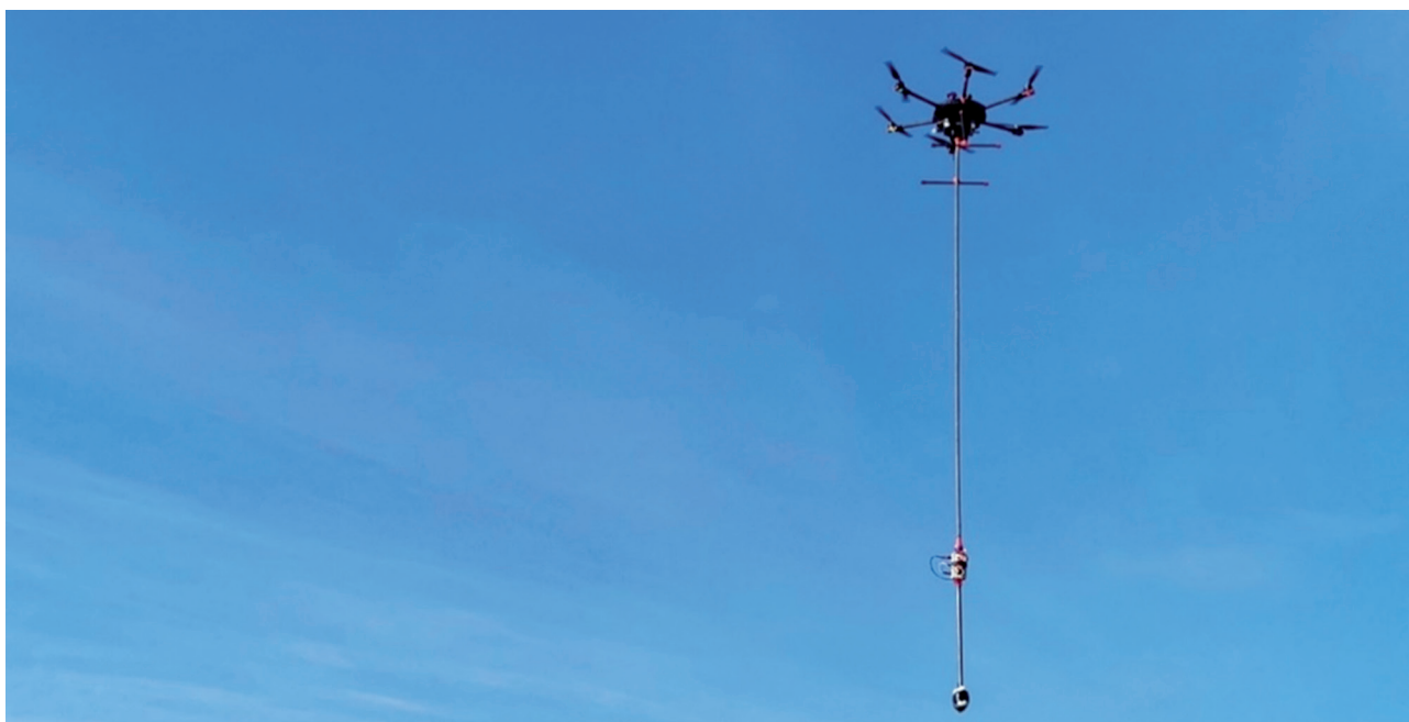
Рис. 2. Мультироторный беспилотный комплекс SibGIS UAS в варианте маловысотной магниторазведки
