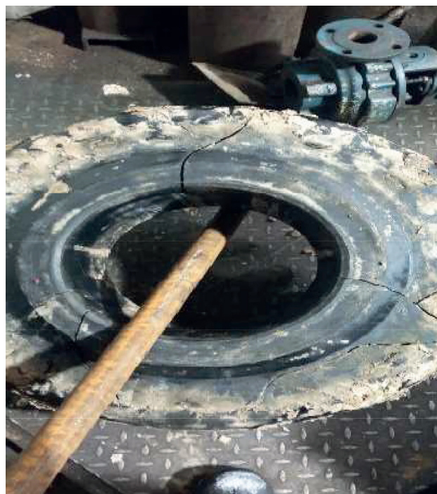
Рис. 3. Поврежденный уплотнительный элемент (фото авторов статьи):
