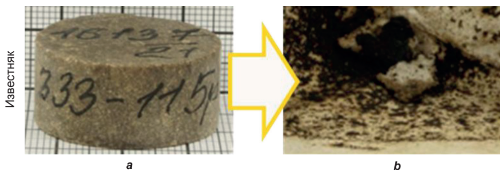
Рис. 5. Изменение структуры карбонатного ядра до (а) и после (б) кислотного воздействия Fig. 5. Changes in the structure of the carbonate core before (a) and after (b) acidizing
