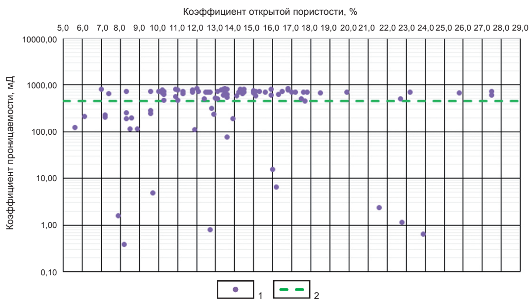
Рис. 2. Соотношение коэффициентов открытой пористости и абсолютной проницаемости K_n/K_{np} песчаников пластов Vbk_1^{bt}-Vcr^{dl} :
