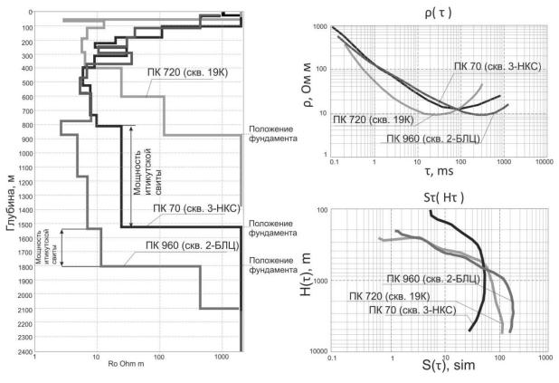
Рис. 2. Типичные кривые зондирования становлением поля в ближней зоне в районе скважин глубокого бурения Fig. 2. Typical curves of TEM sounding in the near zone in the area of deep hole wells
