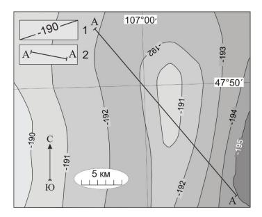
Рис. 2. Схема регионального фона гравитационного поля Богдоулинского гранитного массива ∆G<sup>фон</sup>:
