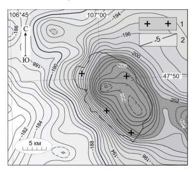
Рис. 1. Схема аномалий Буге Богдоулинского гранитного массива: 1 – выходы гранитов Богдоулинского массива; 2 – изоаномалы силы тяжести, мГал Fig. 1. Diagram of the Bouguer anomalies of the Bogdoulin granite massif: 1 – manifestations of Bogdoulin massif granites; 2 – gravity isoanomalies, mGal
