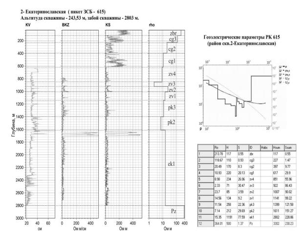
Puc. 1. Геоэлектрическая характеристика разреза в районе скважины 2-Екатеринославской Зее-Буреинского потенциально нефтегазоносного бассейна Fig. 1. Geoelectric characteristic of the section in the area of the 2-Ekaterinoslavskaya well of the Zeya-Bureya potentially oil and gas bearing basin
