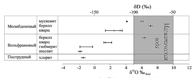
Puc. 5. Изотопные составы кислорода (δ<sup>18</sup>O‰<sub>fluid</sub>) и водорода (δD‰<sub>VSMOW</sub>) во флюидах Булуктаевского месторождения Fig. 5. Isotopic compositions of oxygen (δ<sup>18</sup>O‰<sub>fluid</sub>) and hydrogen (δD‰<sub>VSMOW</sub>) in the fluids of the Buluktai deposit
