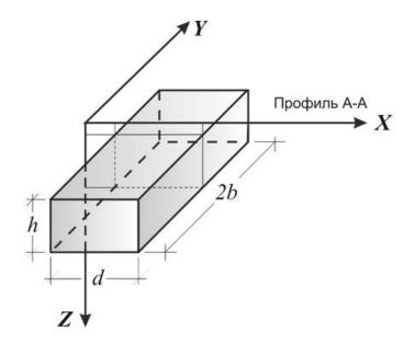
Рис. 5. Положение параллелепипедов и их геометрические параметры относительно интерпретационного профиля А-А Fig. 5. Position of parallelepipeds and their geometrical parameters relative to the interpretation profile A-A
