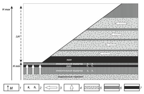
Рис. 4. Расчетная схема вертикальной фильтрации:
