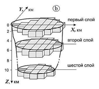
Рис. 6. Схема петроплотностной модели Богдоулинского гранитного массива: а – модель в плоскости интерпретационного разреза A-A: 1– график локальной аномалии  $\Delta G^{
