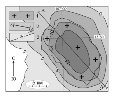
Рис. 3. Схема локальной (остаточной) аномалии Буге Богдоулинского гранитного массива ∆Gлок:
