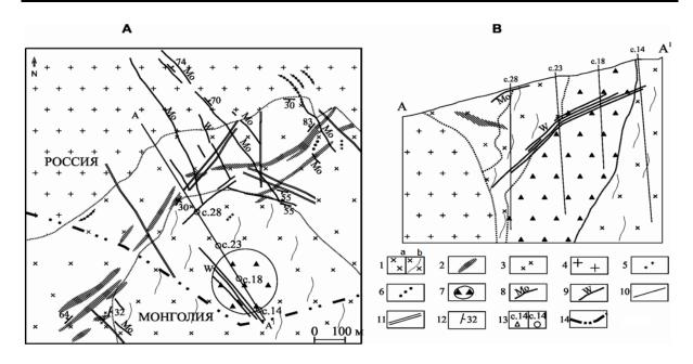
Рис. 1. Схема геологического строения Булуктаевского молибден-вольфрамового месторождения (по источнику [21]):
