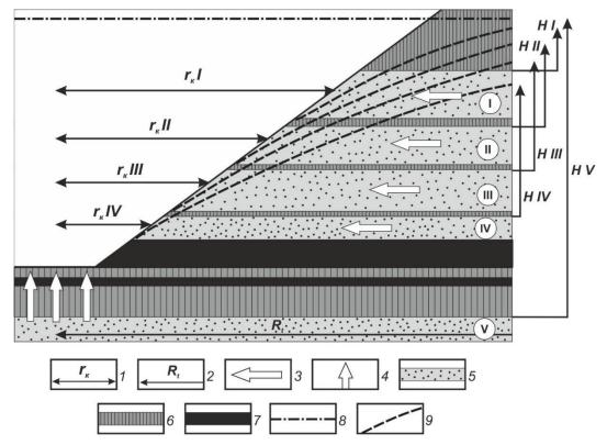
Рис. 3. Схема формирования ожидаемых водопритоков:
