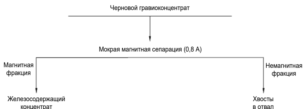
Рис. 2. Технологическая схема доводки гравеоконцентрата методом мокрой магнитной сепарации Fig. 2. Technological scheme of gravity concentrate upgrading by wet magnetic separation
