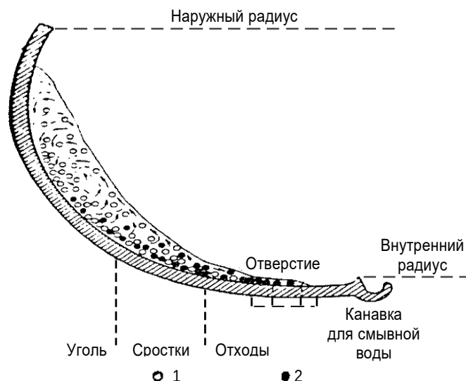
Рис. 2. Поперечное сечение желоба винтового сепаратора: 1 – частицы малого удельного веса; 2 – частицы большого удельного веса Fig. 2. Cross-section of the spiral separator chute: 1 – particles of small specific gravity; 2 – particles of high specific gravity
