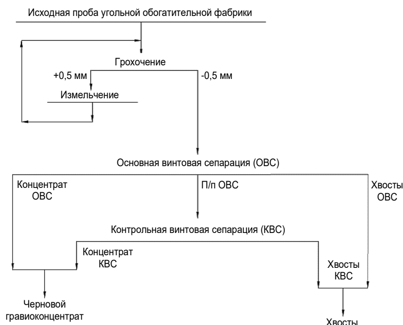
Рис. 1. Технологическая схема обогащения пробы отходов угольной обогатительной фабрики при получении черного гравеоконцентрата
