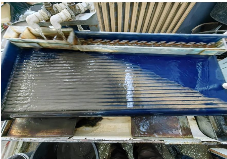
Рис. 3. Процесс обогащения на концентрационном столе Fig. 3. Mineral concentration on the shaking table
