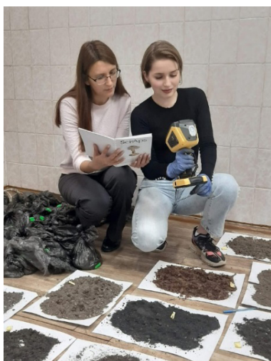
Рентгенофлуоресцентный анализатор SciAps X200 SciAps X200 X-ray fluorescence analyzer
