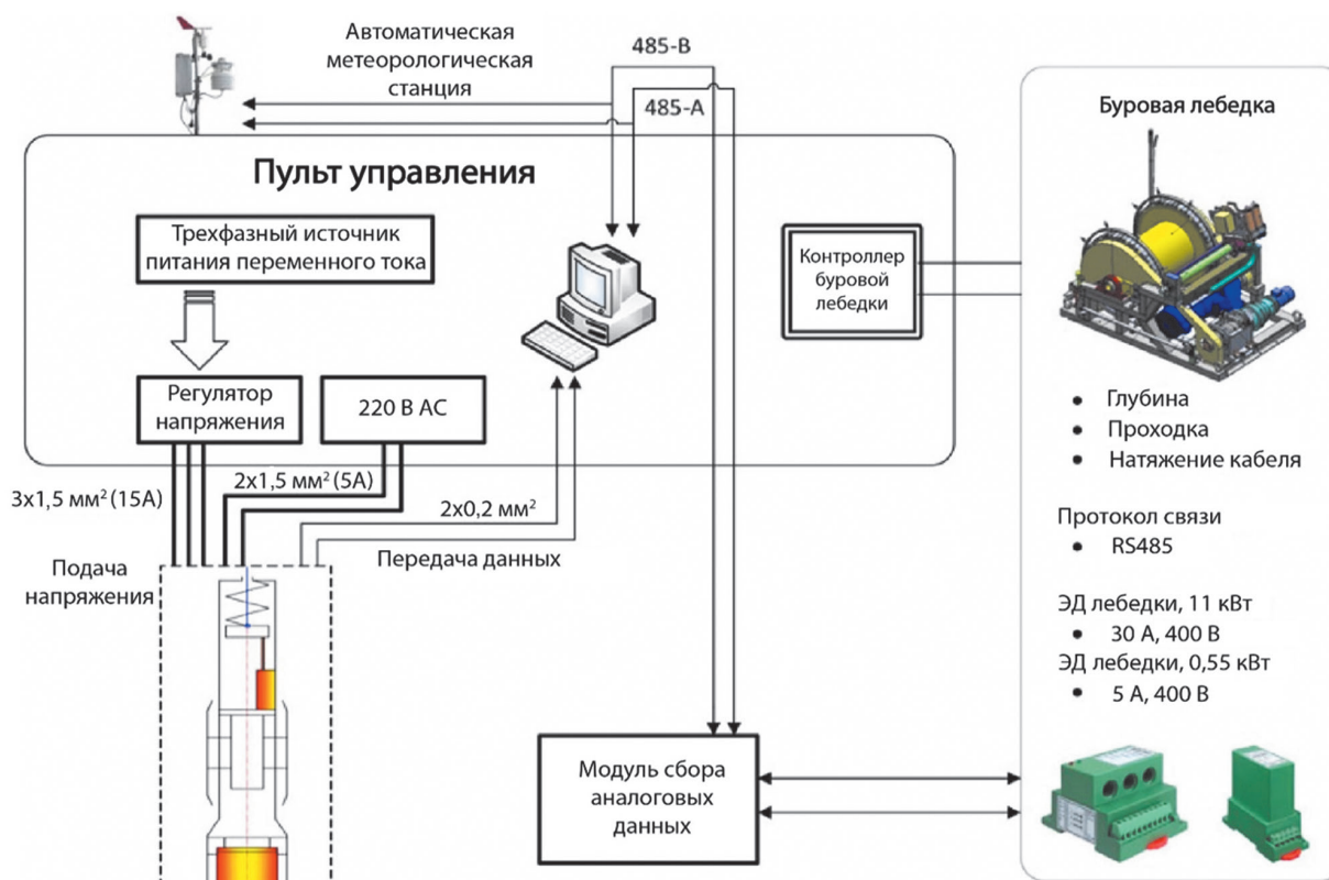
Рис. 4. Система контроля и телеметрии режимных параметров бурения снарядом IBED (согласно источнику [19] с переводом авторов)
