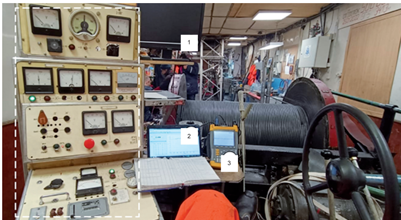
Рис. 1. Система контроля и телеметрии режимных параметров бурения колонковым электромеханическим буровым снарядом:
