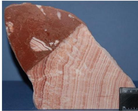
**Рис. 3. Пример дробления пород с поглощением аргиллизитовой массой обломков оникса, кристаллов кальцита и известняка**
