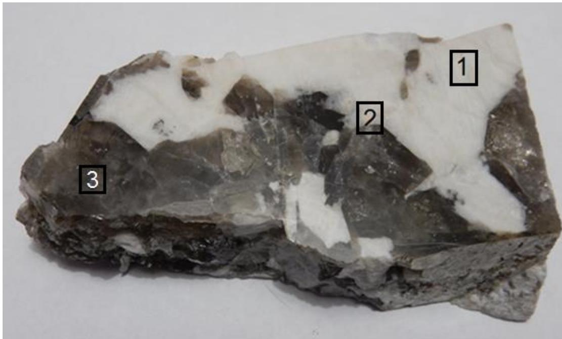
**Рис. 2. Крупно-гигантозернистое строение облицовочной плитки**
